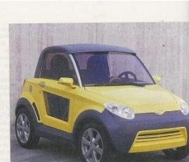
CARROZZERIA IN ACCIAIO E PLASTICA RICICLABILE AL 70%: la carrozzeria riciclabile al 70% ha un totale in tubi di acciaio con verniciatura in plastica. L'air-tyc all'incancrena poi eventi significativi.
